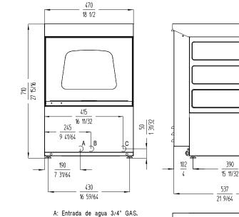
B: Tubo de desague  $\phi$ 30 mm. C: Cable conexión. <u>537</u> <u>21 9/64</u> <u>12 63/64</u>
